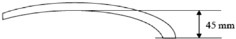
شکل 1-ب- مثالی از اندازه گیری بچه گلگیر بیرونی
